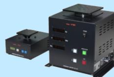
振動検査用加振機
